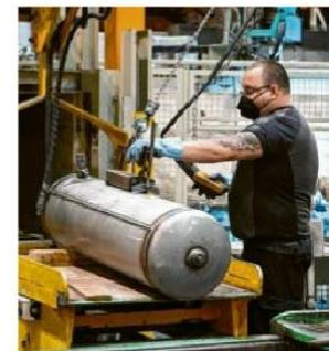
Hier wird ein geschweißter Druckbehälter auf Dichtheit geprüft.
